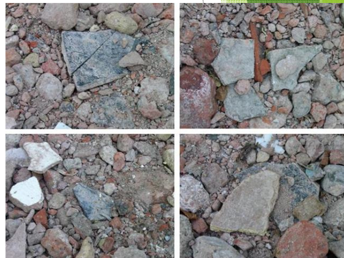
Asbestresten in puin
